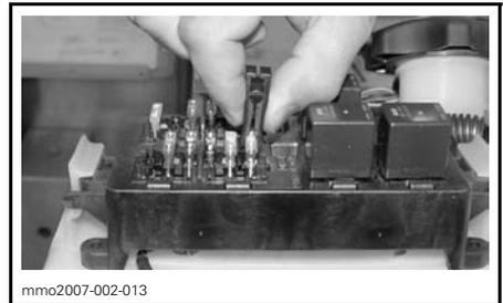
TYPICAL — REMOVE FUSE USING TOOL
