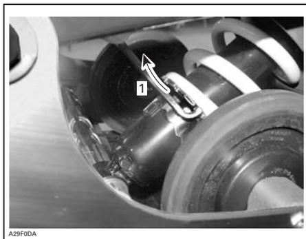
1. Utilizzare la chiave di regolazione fornita con il kit strumenti per aumentare il precarico
