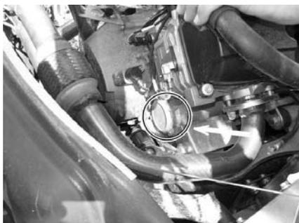
6. Sostituire con una nuova cartuccia del filtro dell'olio.
