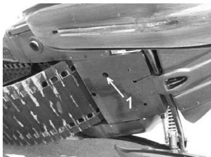
**ATTENZIONE:** Sul modello Yeti-Pro 800 non è possibile utilizzare il tappo di scarico. Utilizzare l'apposita pompa per cambiare l'olio tramite il condotto dell'astina.
