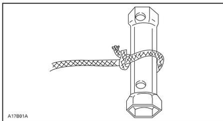
Collegare l'altra estremità della fune di emergenza al fermaglio di avviamento fornito con il kit strumenti.
