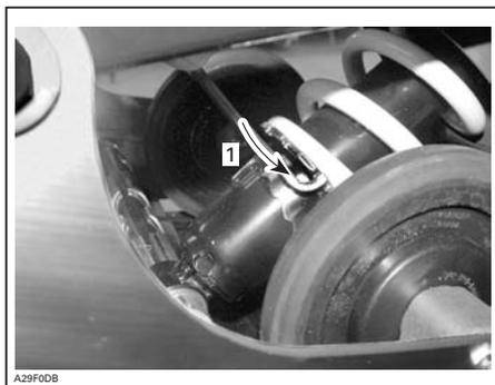
1. Utilizzare la chiave di regolazione fornita con il kit strumenti per ridurre il precarico
