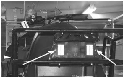
Se la lampadina del fanalino posteriore è fulminata, rimuovere la protezione in plastica rossa per accedere alla lampadina. Per rimuoverla, svitare le 2 viti della protezione.
