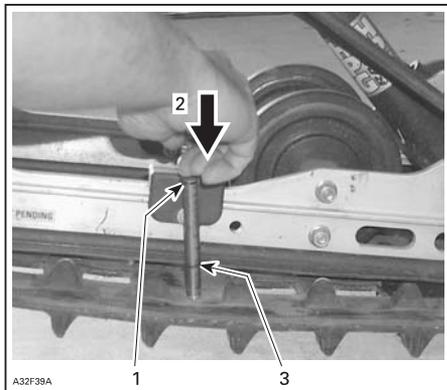
1. La parte superiore dello strumento O-ring posizionata a 7,3 kg
