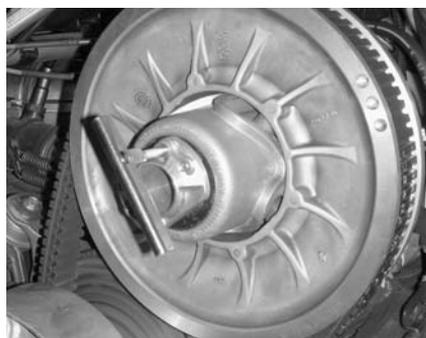
**EXPANDER INSTALLED ON SCREW TYPE DRIVEN PULLEY**
