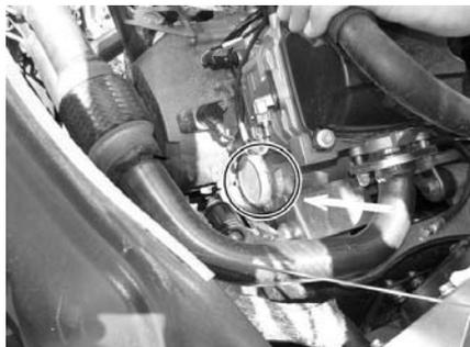
5. Setzen Sie die neue Ölfilterpatrone ein.
