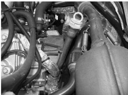
**VORSICHT:** Yeti-Pro 800 . Verwenden Sie eine entsprechende Pumpe, um das Öl durch die Öffnung für den Ölmesstab zu wechseln.
