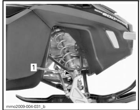
TYPISCH - VORSPANNUNGSEINSTELLUNG DURCH NOCKE
