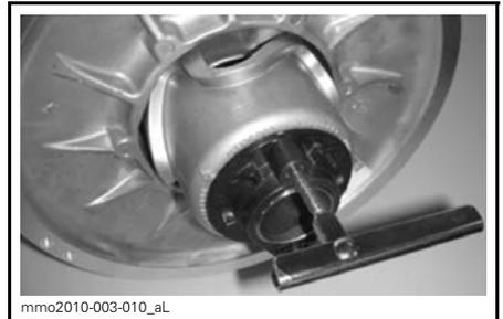
5. Öffnen Sie die Abtriebsscheibe, indem Sie das Werkzeug hineindrehen.
