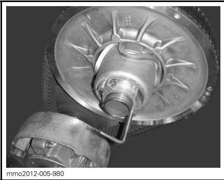
FORLENGER FOR DRIVREIM MONTERT PÅ JUSTERINGSNAV
