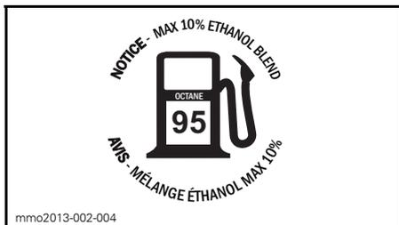
SITUÉE SUR LE BOUCHON DU RÉSERVOIR
