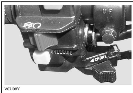
**LEVA DEL DISPOSITIVO DELL'ARIA IN POSIZIONE OFF**
