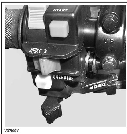
**LEVA DEL DISPOSITIVO DELL'ARIA IN POSIZIONE COMPLETA**
