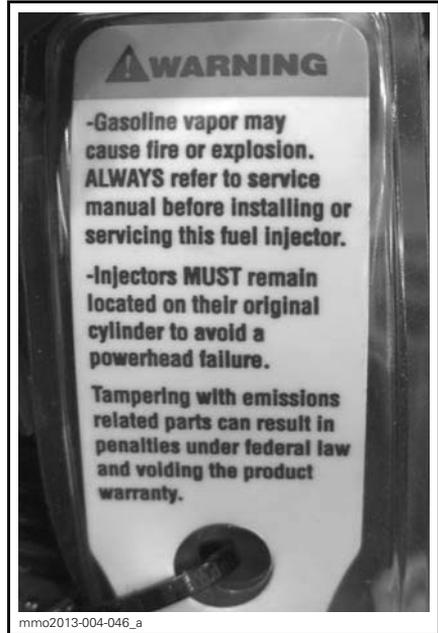
LABEL 7- ON FUEL INJECTORS - E-TEC MODELS
