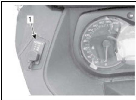
1. Affichage la batterie/prise de mise en charge
