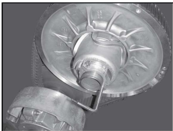
**TYPISCH - SCHEIBEN-EXPANDER AN NABE DER EINSTELLVORRICHTUNG MONTIERT**
