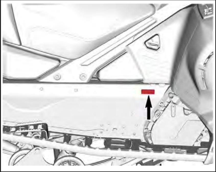
*TIPIQUE - IDENTIFICATION NRMM SUR LE CÔTÉ DROIT DU TUNNEL*
