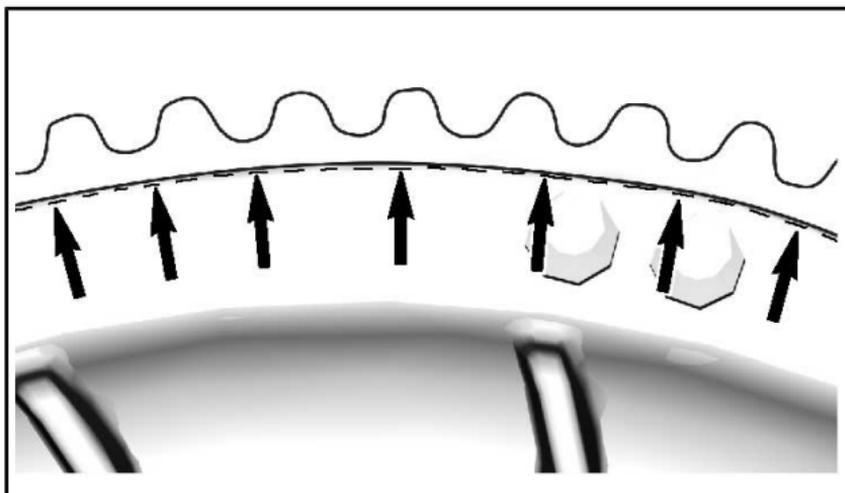
**REMARQUE :** La rotation de l'anneau dans le sens inverse à celui des aiguilles d'une montre abaisse la courroie dans la poulie. La rotation de l'anneau dans le sens des aiguilles d'une montre remonte la courroie dans la poulie.
