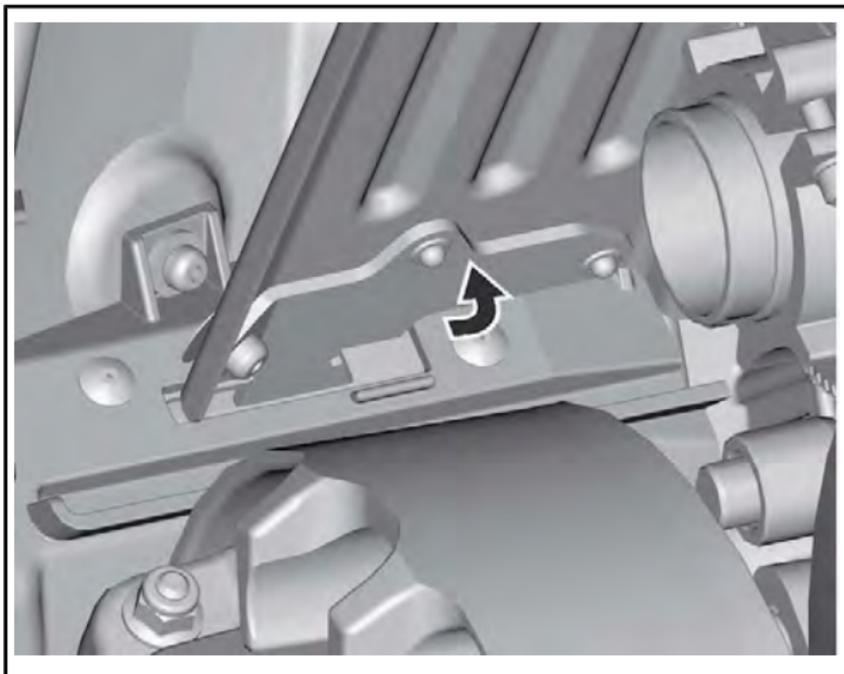
Placez la partie arrière du protège-courroie sur le dispositif de retenue et fixez-le à l'aide de la goupille.
