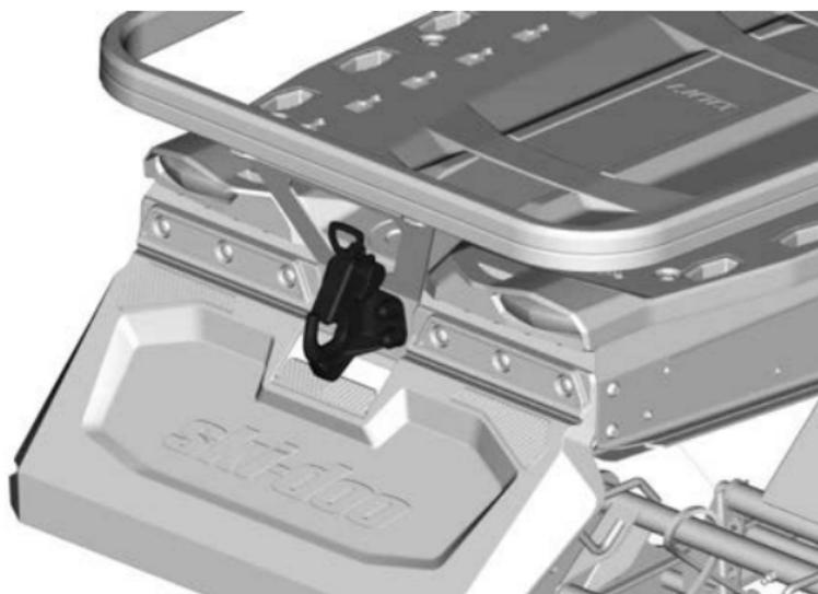
Чтобы открыть крюк нажмите на рукоятку и поверните ее, чтобы опустить стопорную пластину.
