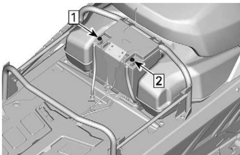
1. Отсоедините отрицательную клемму
