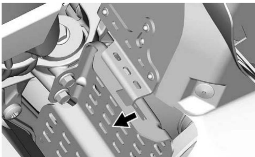
Установите заднюю часть кожуха на держатель и закрепите его с помощью проволочного фиксатора.
