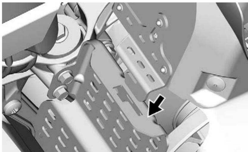
Нажмите на кожух ремня вариатора по направлению к двигателю, а затем в направлении передней части снегохода.
