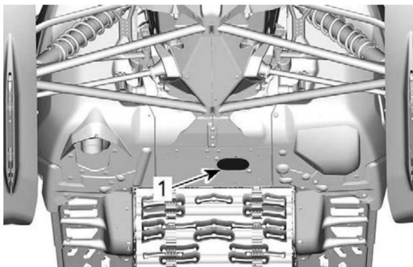
1. Крышка доступа сливных пробок
