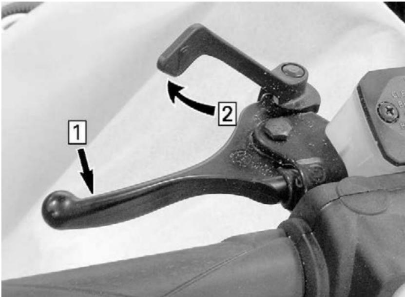
**ТИПОВОЙ ВАРИАНТ – ВКЛЮЧЕНИЕ СТОЯНОЧНОГО ТОРМОЗА**
