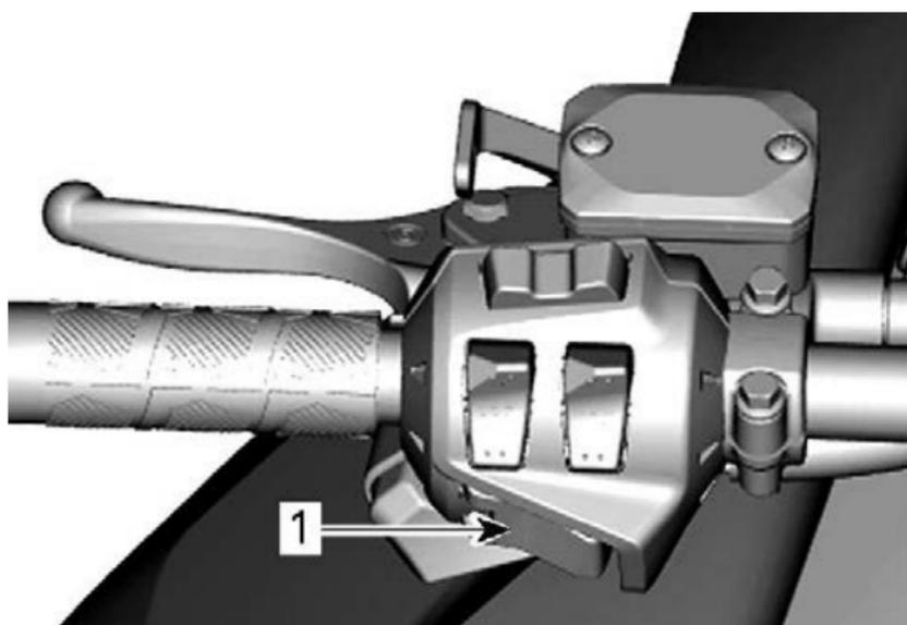
1. Кнопка запуска двигателя/включения электронного реверса
