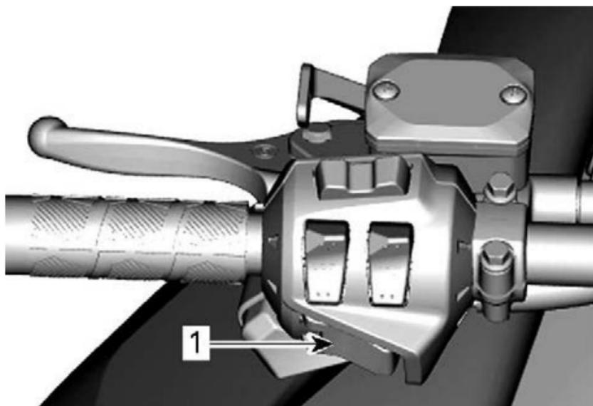
1. Кнопка запуска двигателя/включения электронного реверса
