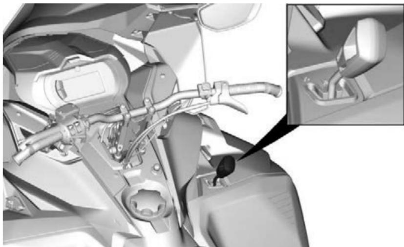
Данный рычаг используется для переключения передач. Коробка передач имеет две передачи переднего хода и нейтральную передачу.
