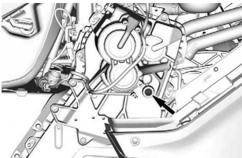
**ПРОБКА ЗАЛИВНОГО ОТВЕРСТИЯ**
