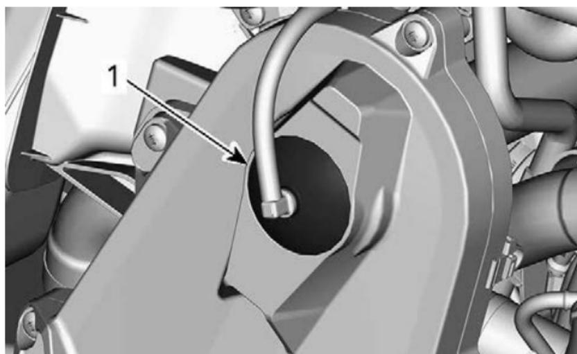
**ТИПОВОЙ ВАРИАНТ — ВЕРХНЯЯ ЧАСТЬ КАРТЕРА ЦЕПНОЙ ПЕРЕДАЧИ**
