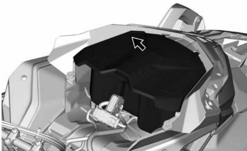
7. Отсоедините разъемы фары и MAPTS (2-тактный двигатель).
