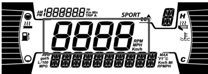
Отображение частоты вращения двигателя в об/мин или скорости транспортного средства в км/ч или милях/ч.
