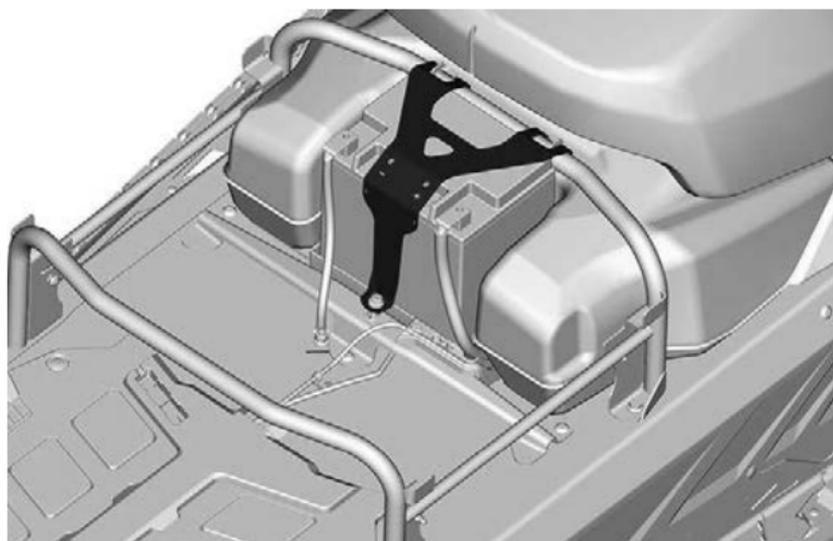
6. Снимите аккумуляторную батарею.
