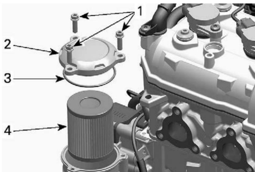
1. Винты крышки масляного фильтра
