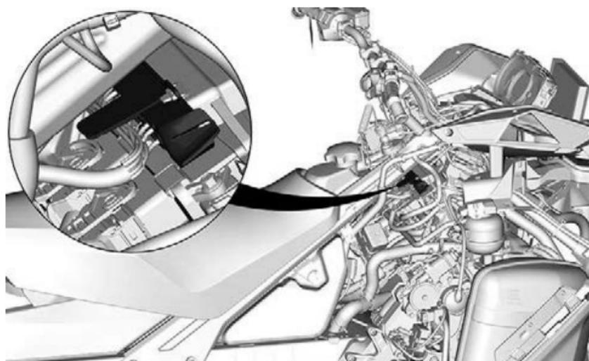
**БЛОК РЕЛЕ — ПРИ НАЛИЧИИ**
