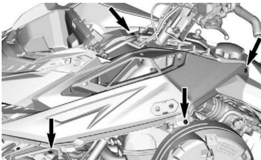
10. Снимите верхнюю панель корпуса.
