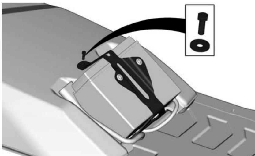
5. Снимите аккумуляторную батарею.
