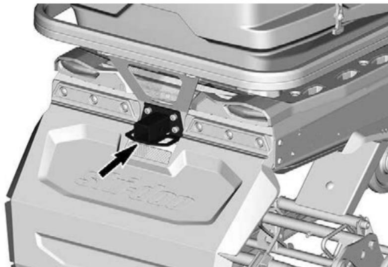
Буксировка груза при использовании сцепного устройства допускается только на жесткой сцепке.
