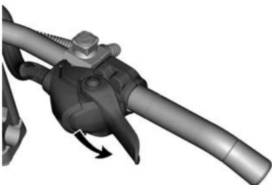
**ИЗМЕНЕНИЕ ПОЛОЖЕНИЯ РЫЧАГА ДРОССЕЛЬНОЙ ЗАСЛОНКИ: НАЖМИТЕ ВНИЗ, ЧТОБЫ ПОВОРНУТЬ УЗЕЛ РЫЧАГА УПРАВЛЕНИЯ ДРОССЕЛЬНОЙ ЗАСЛОНКОЙ**
