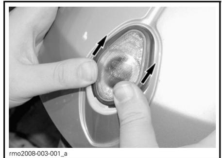
2. Heben Sie den Vorderteil des Glases mit dem Daumen oder einem kleinen Schraubendreher an, um es zu lösen.
