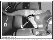
AJUSTE DE LA PALANCA DE EMBRAGUE
