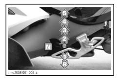
Levante o presione completamente para pasar de una marcha a la siguiente. Cuando se suelta la palanca, vuelve a la posición central, donde se restablece el mecanismo para el siguiente cambio de marcha. El punto muerto (N) se selecciona levantando a medias la palanca desde la primera marcha o bajándola a medias desde la segunda. Consulte p. 48 para obtener instrucciones detalladas.
