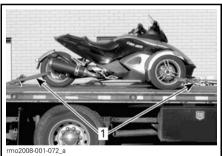
Ruedas delanteras y trasera bien aseguradas al remolque
