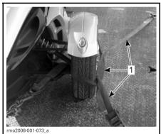
. FIJACIÓN DE LAS RUEDAS DELANTERAS – SEGUNDO MÉTODO
