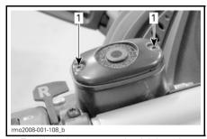
1. Tornillo en la parte superior del depósito
