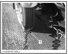
FIJACIÓN DE LAS RUEDAS DELANTERAS – PRIMER MÉTODO
