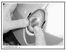
2. Levante la parte delantera de la lente con el pulgar o con un destornillador pequeño para soltarla.
