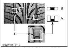
DESGASTE DE LA BANDA DE RODADURA
