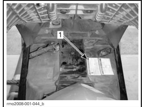
1. Étiquette de l'EPA sur les émissions d'échappement (située sous le siège)
