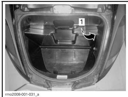
1. Nécessaire d'outils situé à l'avant du compartiment de rangement avant
