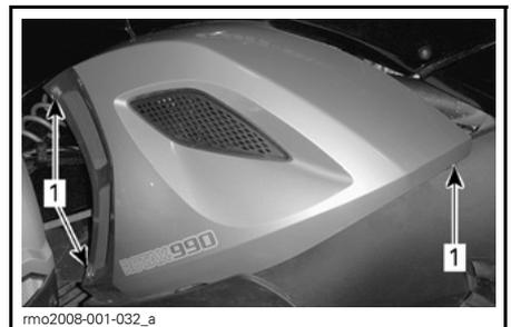
1. Clips der mittleren Seitenverkleidung
