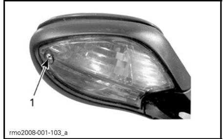
1. Schraube am Glas der vorderen Blinkerlampe
