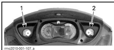
1. Indicador de temperatura de refrigerante del motor
