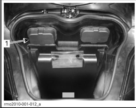
1. Sicherungskasten im vorderen Staufach
