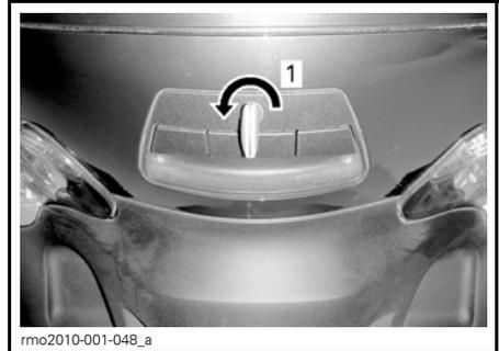
1. Zum Entriegeln gegen den Uhrzeigersinn drehen
