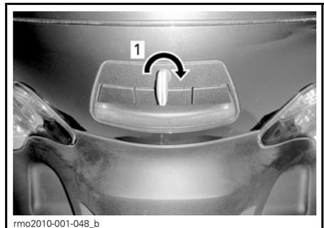
1. Zum Verriegeln im Uhrzeigersinn drehen
