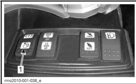
1. Schalter zum Öffnen des vorderen Staufachs
