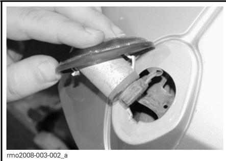
3. Drehen Sie die Lampenfassung im Uhrzeigersinn und lösen Sie sie vom Stecker.
