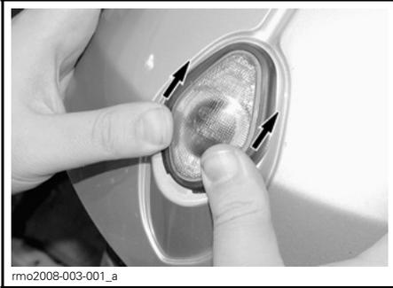
2. Heben Sie den Vorderteil des Glases mit dem Daumen oder einem kleinen Schraubendreher an, um es zu lösen.
