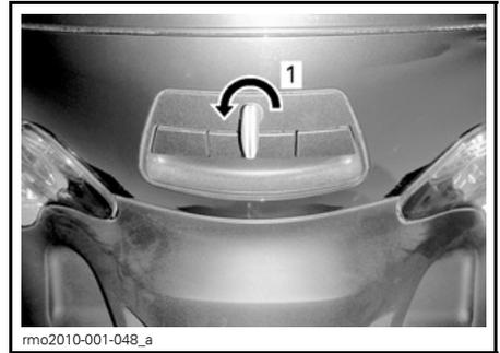
1. Zum Entriegeln gegen den Uhrzeigersinn drehen
