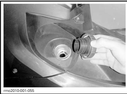
FUEL CAP ON LEFT SIDE UNDERNEATH SEAT
