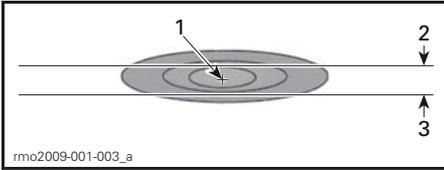
**PROJEÇÃO NORMAL DO FAROL NA SUPERFÍCIE DE TESTE — FAROL ALTO**
