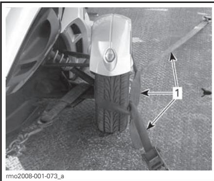
**FIXAÇÃO DAS RODAS DIANTEIRAS — MÉTODO 2**
