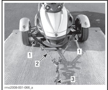
1. Correia em volta dos braços inferiores da suspensão dianteira
