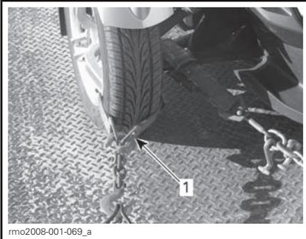
**FIXAÇÃO DAS RODAS DIANTEIRAS — MÉTODO 1**
