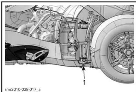
1. Écrou de fixation avant
