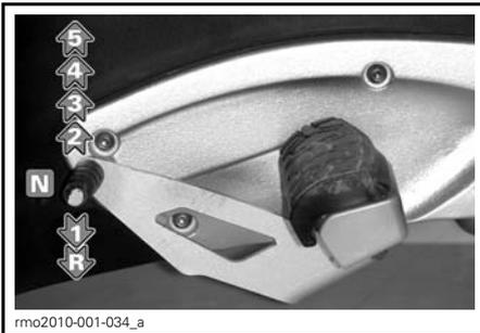
Soulevez le levier de changement de vitesses ou appuyez dessus pour passer d'une vitesse à l'autre. Lorsque vous relâchez le levier, il retourne automatiquement en position centrale où le mécanisme est réinitialisé en vue de la prochaine sélection. Pour sélectionner le point mort (N), soulevez le levier de changement de vitesses à mi-chemin vers le haut ou appuyez à mi-chemin depuis la deuxième vitesse. Consul-
