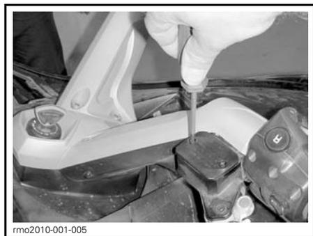
6. Retirez délicatement le couvercle. Faites attention de ne pas échapper l'anneau d'étanchéité du couvercle.
