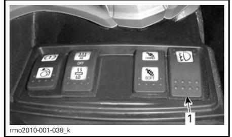
1. Interrupteur de phares antibrouillard
