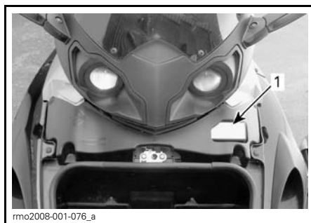
1. Sicherungskasten unter der Wartungsabdeckung hinter dem vorderen Staufach
