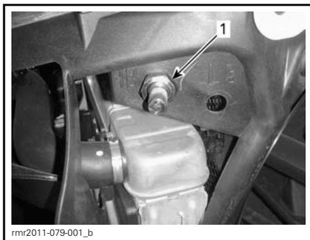
1. Écrou de fixation du câble de réglage
