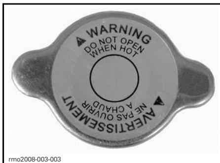
BOUCHON DU RÉSERVOIR DE LIQUIDE DE REFROIDISSEMENT
