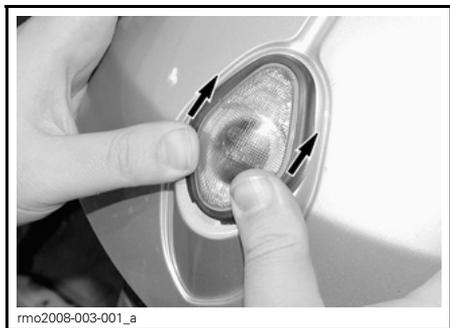
2. Levante la parte delantera de la lente con el pulgar o con un destornillador pequeño para soltarla.
