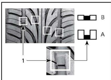
**DESGASTE DE LA BANDA DE RODADURA**
