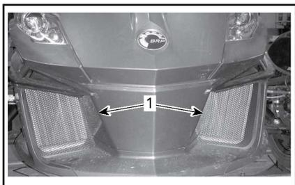
1. Rejillas del ventilador del radiador
