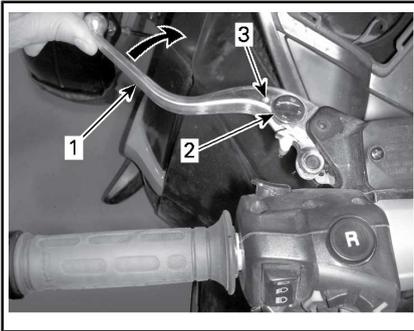
**AJUSTE DE LA PALANCA DE EMBRAGUE**
