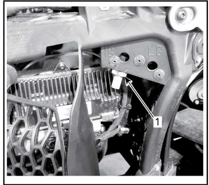
1. Tuerca de sujeción del cable de ajuste
