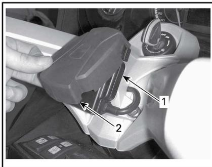
1. Base de GPS con placa de recubrimiento instalada
