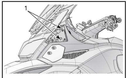
1. Tornillos de sujeción de la parte superior
