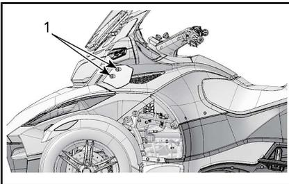
1. Tornillos de sujeción del derivabrisas
