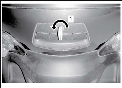
1. Zum Entriegeln gegen den Uhrzeigersinn drehen
