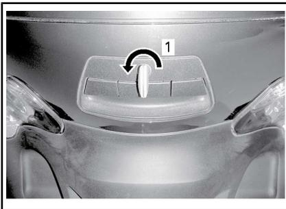
1. Zum Entriegeln gegen den Uhrzeigersinn drehen
