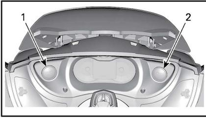
1. Anzeigeeinstrument für Kraftstoffstand
