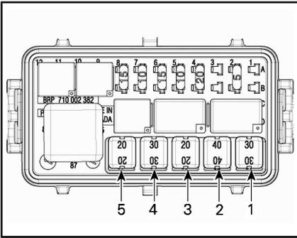
J-KASTEN-SICHERUNGEN - RECHTER SICHERUNGSKASTEN
