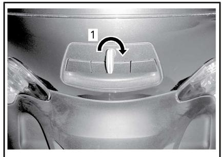
1. Zum Verriegeln im Uhrzeigersinn drehen
