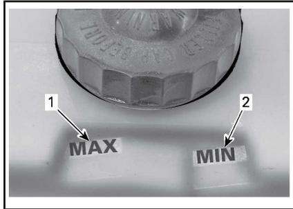
1. *Markierung für max. Bremsflüssigkeitsstand*
