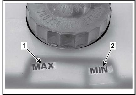
1. Marca de nivel MÁXIMO del líquido de frenos
