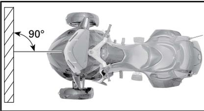
Trace 2 líneas paralelas al suelo en la superficie de prueba, como se muestra:
