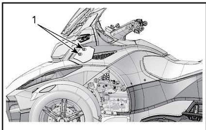
1. Tornillos de sujeción del derivabrisas
