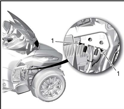
1. Tuercas de sujeción del cable de ajuste
