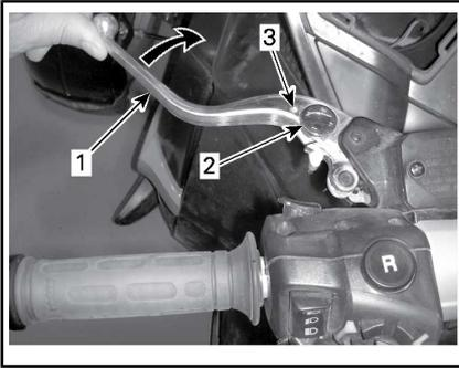
**AJUSTE DE LA PALANCA DE EMBRAGUE**
