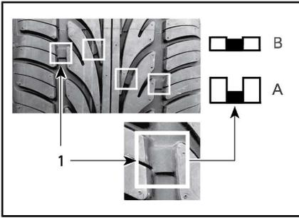
**DESGASTE DE LA BANDA DE RODADURA**
