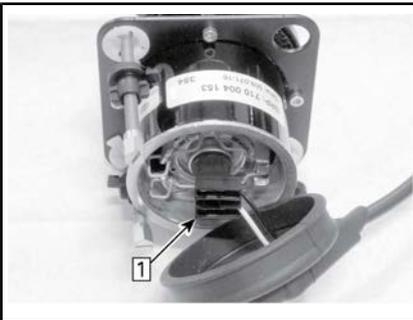
Schritt 1: Entfernen Sie den Anschluss von der Glühlampe
