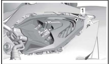
**RIMOZIONE DEL PANNELLO DELLA CONSOLE**
