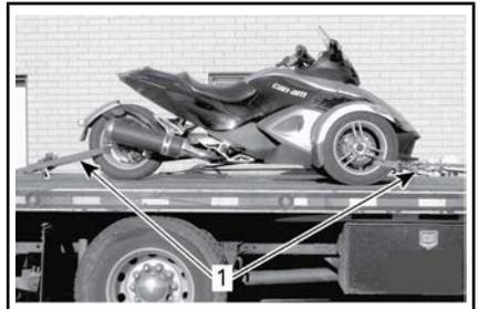
1. Vorderräder und Hinterrad sicher am Anhänger befestigt
