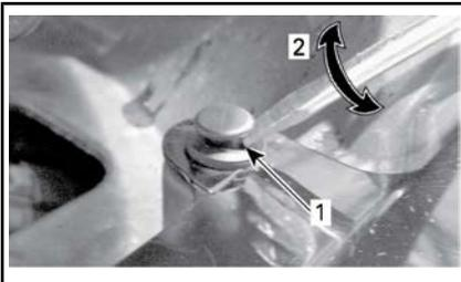
1. Flachkopf-Schraubendreher unter dem Nietkopf
