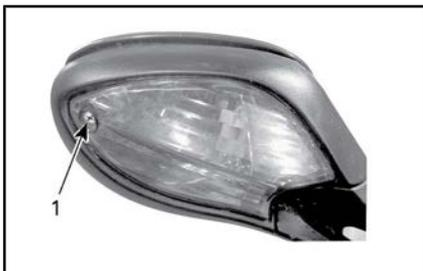
1. Schraube am Glas der vorderen Blinkerlampe
