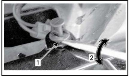
1. Flachkopf-Schraubendreher unter dem Niet
