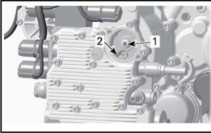
1. Ölauslassöffnung zum Schmiersystem des hydraulischen Steuergeräts
