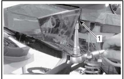
1. Entfernung der Torx-Schraube hinter dem Glas
