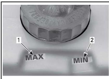
1. Markierung für max. Bremsflüssigkeitsstand
