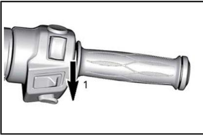
**ZUVOR EINGESTELLTE BZW. GESPEICHERTE GESCHWINDIGKEIT**
