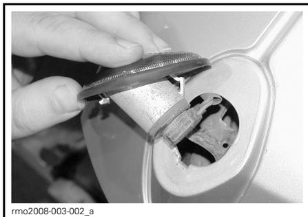
3. Tournez le logement d'ampoule dans le sens horaire pour le retirer du connecteur.
