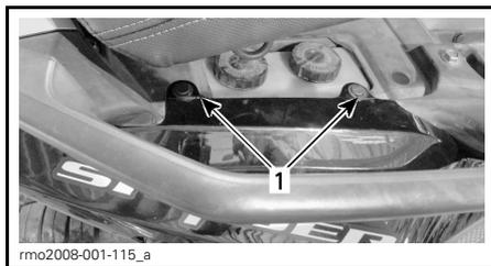
1. 2 rivets de plastique sous le siège
