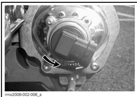
**AVIS** Ne jamais toucher la partie de verre d'une ampoule halogène avec les doigts; cela réduit sa durée. Si on y a touché, la nettoyer avec de l'alcool isopropylique pour enlever le film gras laissé par les doigts.
