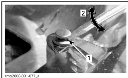
1. Tournevis à tête plate sous la tête du rivet
