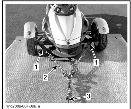
1. Mettez la courroie autour des bras inférieurs de suspension avant
