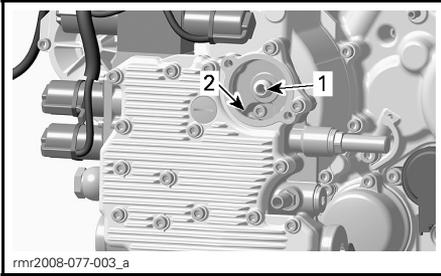
1. Orifice de sortie allant au système de lubrification du module de commande hydraulique
