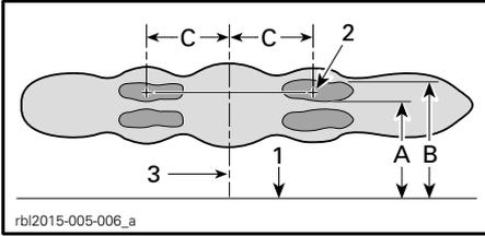
**RÉFLEXION DES FEUX DE ROUTE SUR UNE SURFACE D'ESSAI (LES DEUX PHARES)**
