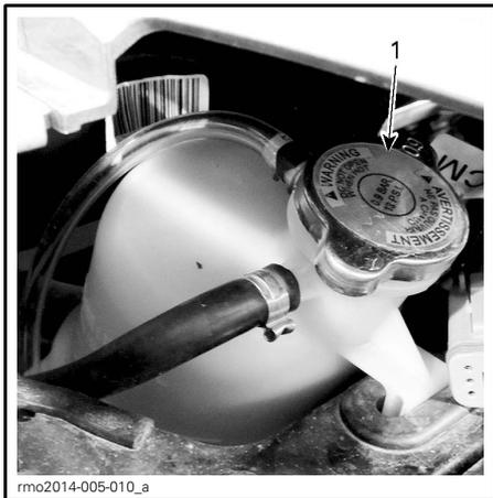
1. Bouchon du réservoir de liquide de refroidissement
