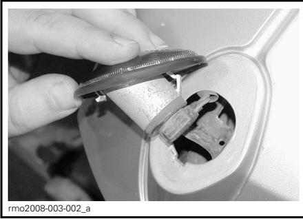
3. Tournez le logement d'ampoule dans le sens horaire pour le retirer du connecteur.
