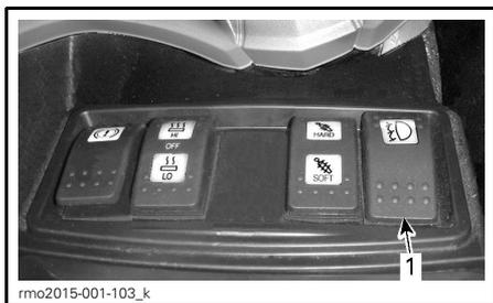
1. Interrupteur de phares antibrouillard
