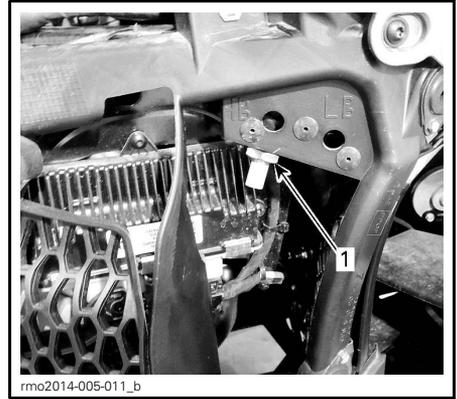
1. Écrou de fixation du câble de réglage
