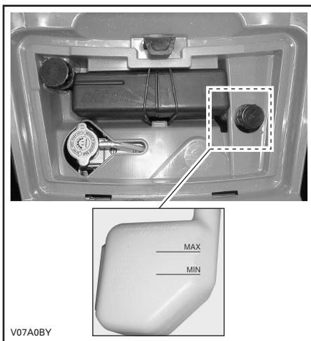
Se il veicolo si trova su una superficie piana, il livello del liquido dovrebbe essere compreso tra le tacche di MIN e MAX del serbatoio liquido refrigerante.
