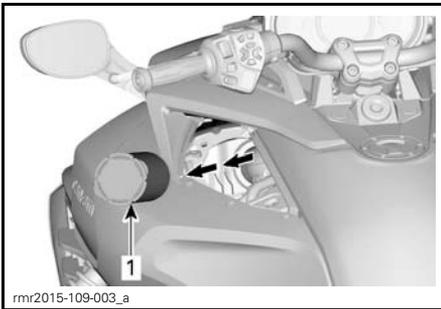
**TYPICAL - REMOVE AIR FILTER FROM AIR INTAKE SILENCER.**
