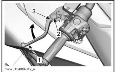
**TYPICAL - CLUTCH LEVER ADJUSTMENT**
