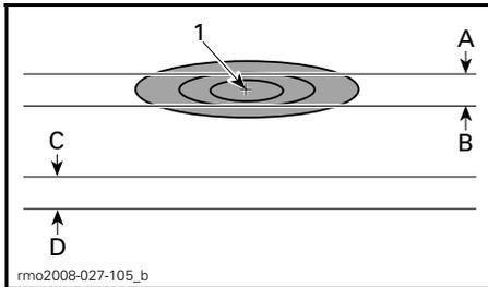
**TYPICAL - HEADLIGHT REFLECTION ON TEST SURFACE — HIGH BEAM (SINGLE HEADLAMP)**
