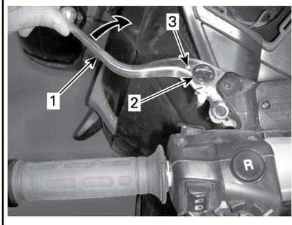
**AJUSTE DE LA PALANCA DE EMBRAGUE**
