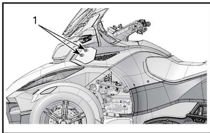
1. Tornillos de sujeción del derivabrisas
