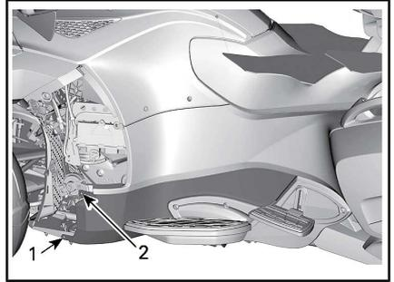
1. Tornillo de sujeción de la parte inferior
