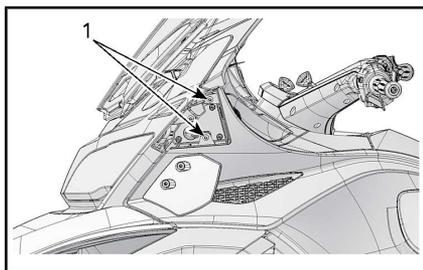
1. Tornillos de sujeción de la parte superior
