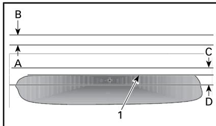
TÍPICO - REFLEJO DEL FARO EN LA SUPERFICIE DE PRUEBAS (UN SOLO FARO)
