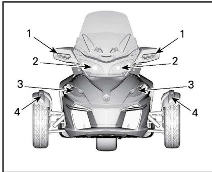
**UBICACIÓN NORMAL DE LAS LUCES: PARTE DELANTERA DEL VEHÍCULO (TODOS LOS MODELOS EXCEPTO LOS MODELOS EUROPEOS)**
