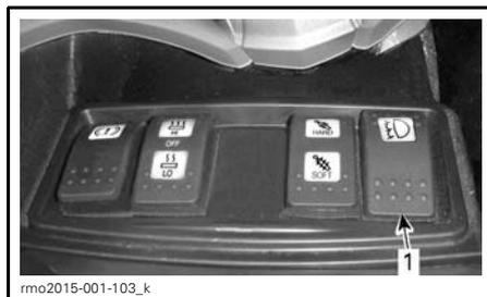
1. Interrupteur de phares antibrouillard
