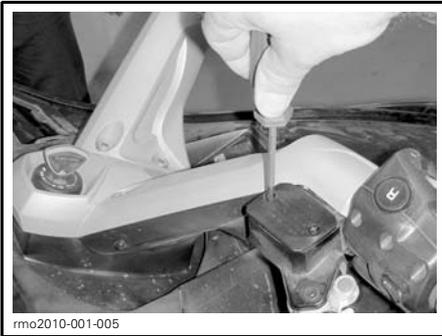
6. Retirez délicatement le couvercle. Faites attention de ne pas échapper l'anneau d'étanchéité du couvercle.
