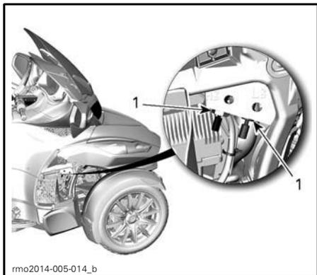
1. Écrous de fixation du câble de réglage
