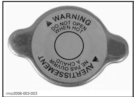
BOUCHON DU RÉSERVOIR DE LIQUIDE DE REFROIDISSEMENT
