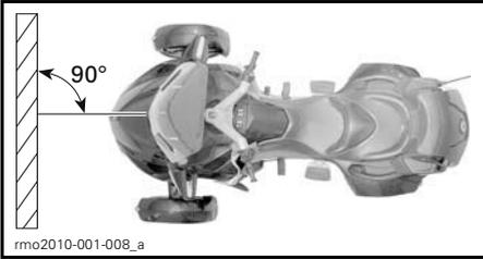
4. En procédant de la façon indiquée ci-dessous, tracez sur la surface d'essai 4 lignes parallèles au sol:
