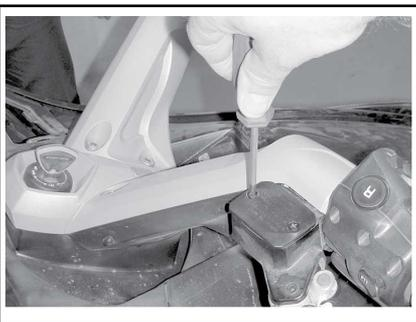
6. キャップを慎重に取り外します。キャップのシールを落さないように注意してください。
