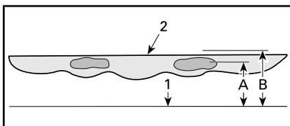
試験面の通常のヘッドライトの反射（両方のヘッドライト）
