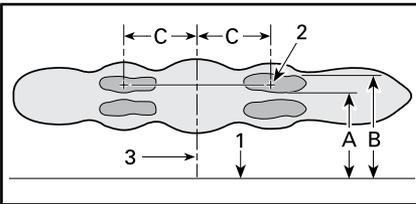
試験面のハイビームのヘッドライトの反射
