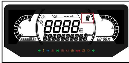
Diese Anzeige zeigt die Getriebesstellung an:
