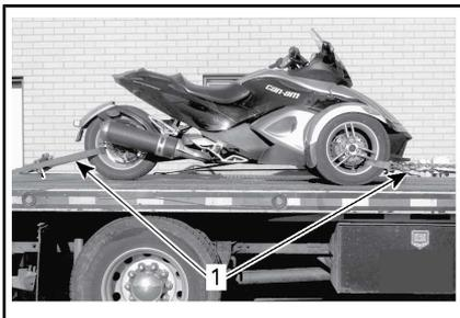
**TYPISCH – FAHRZEUG IST IN RICHTUNG ANHÄNGERVORDERSEITE AUSGERICHTET**
