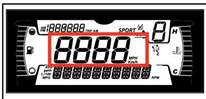
Indique la vitesse du véhicule en km/h ou en mi/h.
