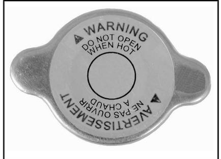
**BOUCHON DU RÉSERVOIR DE LIQUIDE DE REFROIDISSEMENT**
