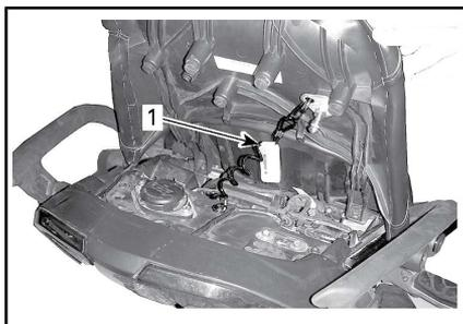
1. Étiquette 6 fixée au cordon d'attache, sous le siège du passager
