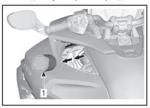
ТИПОВОЙ ВАРИАНТ — СНИМИТЕ ВОЗ-ДУШНЫЙ ФИЛЬТР С ГЛУШИТЕЛЯ ШУМА ВСАСЫВАНИЯ ВОЗДУХА
