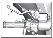
ТИПОВОЙ ВАРИАНТ — РЕГУЛИРОВКА РЫЧАГА СЦЕПЛЕНИЯ
