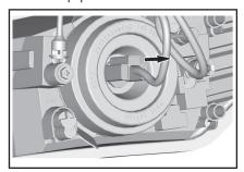
13. Снимите крышку корпуса.
