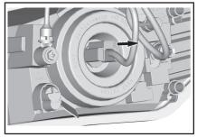
10. Снимите резиновую крышку корпуса.
