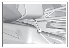
Пластиковый фиксатор под передней частью бокового кофра
