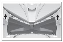
ТИПОВОЙ ВАРИАНТ — СДВИГАНИЕ КРЫШКИ ОБСЛУЖИВАНИЯ НА МЕСТО
