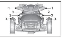
ТИПОВОЙ ВАРИАНТ — РАСПОЛОЖЕ-НИЕ СВЕТОВЫХ ПРИБОРОВ — ПЕРЕД-НЯЯ ЧАСТЬ ТРАНСПОРТНОГО СРЕД-СТВА — F3-T И F3 — МОДЕЛИ ДЛЯ ЕВ-РОПЫ, АВСТРАЛИИ И ЯПОНИИ
