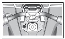
Кнопка включения подогрева рукояток водителя
