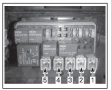
ПРЕДОХРАНИТЕЛИ В ИНДИВИДУАЛЬНОМ КОРПУСЕ — ЛЕВЫЙ БЛОК ПРЕДОХРАНИТЕЛЕЙ
