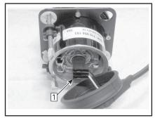
Шаг 1: Отсоедините электрический разъем от лампы светового прибора.
