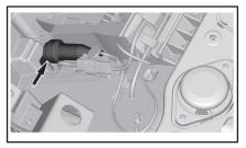
dc56— ЦЕПЬ ДЛЯ ПОДКЛЮЧЕНИЯ ДО-ПОЛНИТЕЛЬНОГО ОБОРУДОВАНИЯ В ЗАДНЕЙ ЧАСТИ— ПОД СИДЕНЬЕМ ПАССАЖИРА
