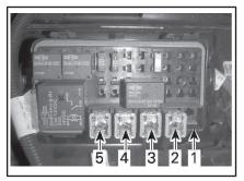
ПРЕДОХРАНИТЕЛИ В ИНДИВИДУАЛЬНОМ КОРПУСЕ — ПРАВЫЙ БЛОК ПРЕДОХРАНИТЕЛЕЙ
