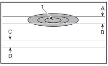
ТИПОВОЙ ВАРИАНТ — СВЕТ ФАРЫ НА ПРОВЕРОЧНОЙ ПОВЕРХНОСТИ — ДАЛЬНИЙ СВЕТ (ОДНА ФАРА)
