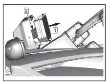
Шаг 1: Снимите приборную панель Шаг 2: отсоедините
