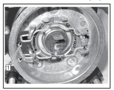
Шаг 1: Снимите пружинные фиксаторы.
