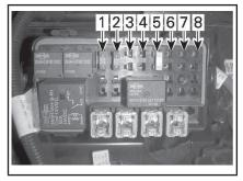
ПРЕДОХРАНИТЕЛИ — ПРАВЫЙ БЛОК ПРЕДОХРАНИТЕЛЕЙ
