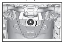
10. Снимите окантовку замка зажигания.
