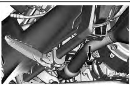
4. Placez un bac de récupération sous le bouchon de vidange magnétique.
