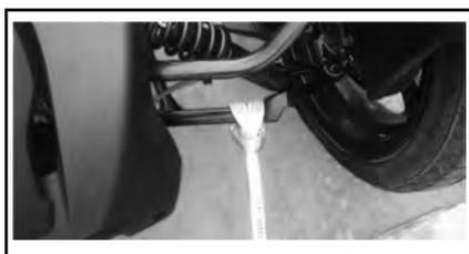
3. Attachez les courroies au câble de treuil.
