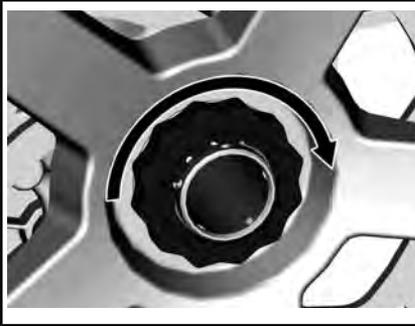
Retirer le dispositif de blocage du moyeu de roue.
