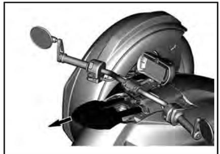
4. Insérez lentement le bec de ravitaillement dans l'e col du réservoir après en avoir retiré le bouchon et laissez le bec
