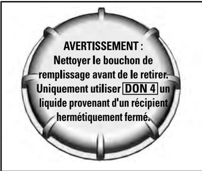
BOUCHON DU RÉSERVOIR DE LIQUIDE DE FREIN
