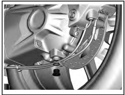
5. Retirez le bouchon de remplissage.
