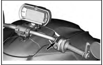
Pour démarrer le moteur, placez l'interrupteur d'arrêt du moteur à la position MARCHE.
