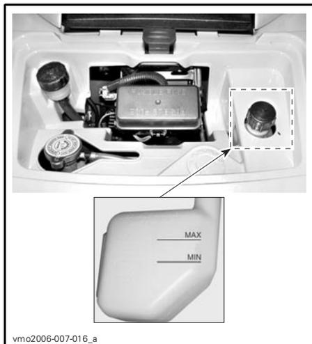
Le véhicule sur une surface de niveau, le niveau de liquide doit être entre les marques MIN. et MAX. du réservoir.
