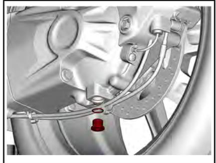
5. Retirez le bouchon de remplissage.
