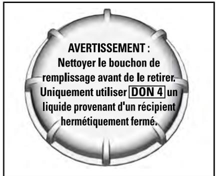
BOUCHON DU RÉSERVOIR DE LIQUIDE DE FREIN
