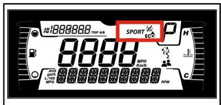
L'afficheur MODE indique le mode de conduite sélectionné :
