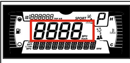
Indique la vitesse du véhicule en km/h ou en mi/h.
