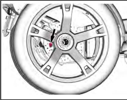
4. Vérifier le niveau d'huile. Le niveau d'huile doit être à égalité avec le bord de l'orifice de niveau d'huile.
