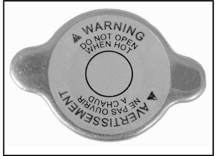
BOUCHON DU RÉSERVOIR DE LIQUIDE DE REFROIDISSEMENT
