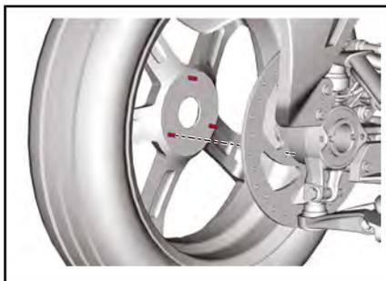
Posez la rondelle conique et le contre-écrou central de la roue.
