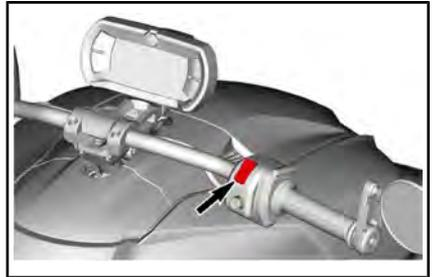
Pour démarrer le moteur, placez l'interrupteur d'arrêt du moteur à la position MARCHÉ.
