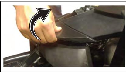
4. Tirez le carénage vers l'avant pour le dissocier du véhicule.
