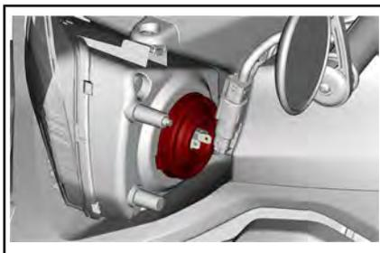
4. バルブストッパーを反時計方向に回してロックを解除します。
