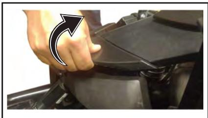
4. フロントフェイスアの下のをねじを取り付けて、手だけで締め付けます。
