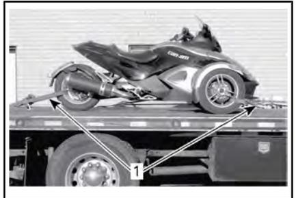
**TYPISCH – FAHRZEUG IST IN RICHTUNG ANHÄNGERVORDERSEITE AUSGERICHTET**
