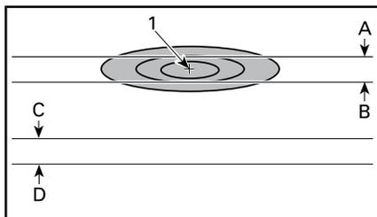
**NORMAL – SCHEINWERFERREFLEKTION AUF TESTOBERFLÄCHE – FERNLICHT (EINZELSCHEINWERFER)**
