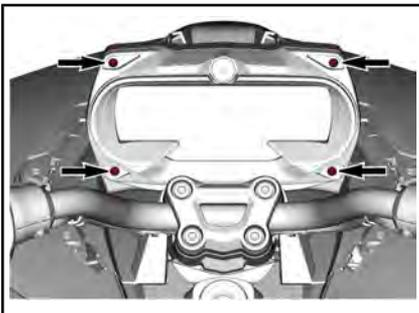
4. Bauen Sie die Anzeige ab, indem Sie die Halteungen zusammendrücken und den Stecker abziehen.
