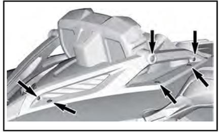
2. Entfernen Sie die Halteschrauben, die die oberen Leisten am Fahrzeug sichern.
