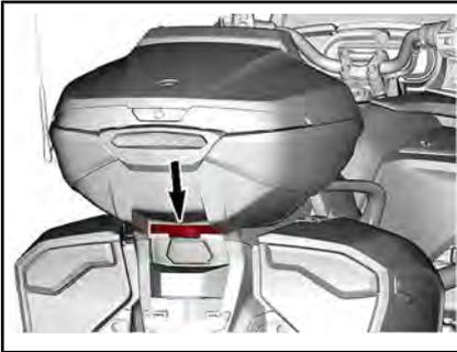
4. Heben Sie das Staufach leicht an und schieben Sie Ihre Hand darunter, um den Steckverbinder neben dem Mitfahrersitz abzuziehen.
