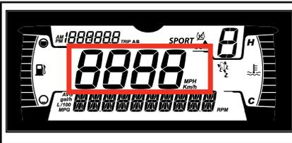
Anzeige der Fahrzeuggeschwindigkeit in km/h oder mph.
