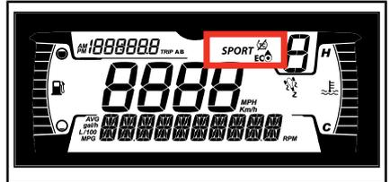
Auf der MODE-Anzeige wird der ausgewählte Fahrmodus angegeben:
