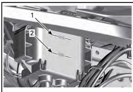
1. Markierung für max. Bremsflüssigkeitsstand
