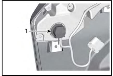
1. Drehen Sie die Lampenfassung im Uhrzeigersinn, um sie zu lösen.
