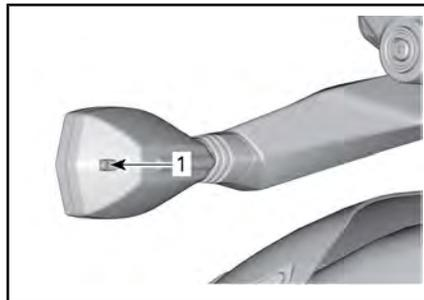
1. Schraube am Glas der hinteren Blinkerlampe
