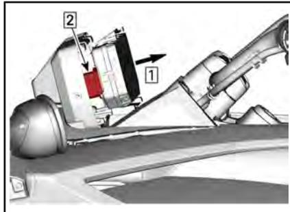
Schritt 1: Anzeigeelement ausbauen
