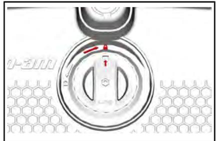
6. Ergreifen Sie das Staufach und prüfen Sie, ob es ordnungsgemäß im Fahrzeug eingebaut und verriegelt ist.
