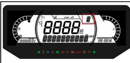
Diese Anzeige zeigt die Getriebestellung an:
