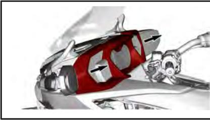
7. Entfernen Sie die seitliche Konsolenverkleidung.
