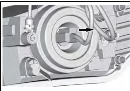
10. Ziehen Sie die Gummiabdeckung des Gehäuses heraus.
