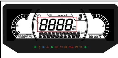
Zeigt die Fahrzeuggeschwindigkeit in km/h oder mph an.
