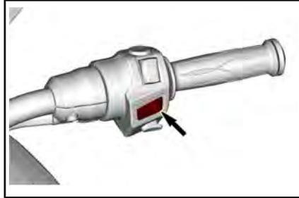
Bei dem Schalter handelt es sich um einen Multifunktionsschalter. Die Geschwindigkeitsregelung kann damit aktiviert, eingestellt und ausgeschaltet werden.
