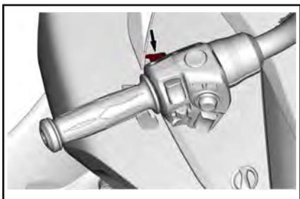
**HINWEIS:** Der Schalter für BRP Connect dient zum direkten Zugriff auf BRP Connect. Mit jeder Betätigung wird zwischen der App-Ansicht und der Funktionsansicht der Multifunktionsanzeige umgeschaltet.
