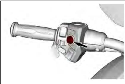
Das ECC ist ein Multifunktionsschalter, es ermöglicht die Steuerung zahlreicher Funktionen des Multifunktions-Anzeigeelements.
