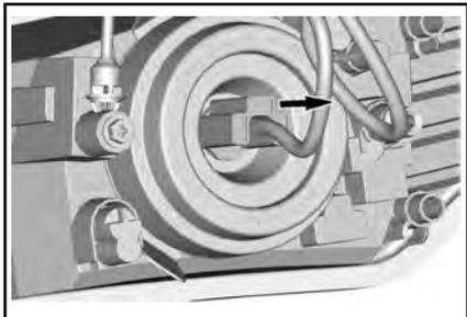
10. Retirez le couvercle de boîtier en caoutchouc.
