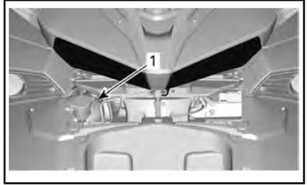
1. Bouchon du réservoir de liquide de refroidissement
