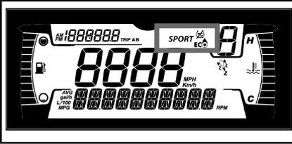
L'afficheur MODE indique le mode de conduite sélectionné :
