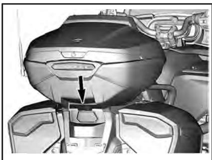
4. Soulevez légèrement le compartiment de rangement et glissez la main en dessous pour débrancher le connecteur.
