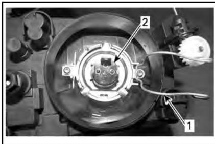
1. Ressort de retenue d'ampoule
