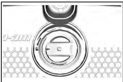
3. Avec la poignée arrière, déverrouillez le compartiment de rangement supérieur du véhicule.
