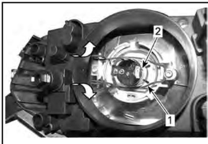
1. Ressort de retenue d'ampoule
