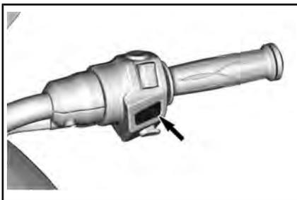
L'interrupteur est multifonctionnel servant à activer, à régler et à désactiver le régulateur de vitesse.
