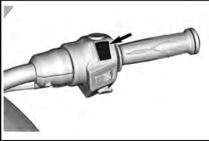
Ce bouton a deux positions. Il doit être sur la position Marche avant pour démarrer le moteur. Grâce à lui, on peut arrêter le moteur sans lâcher le guidon.
