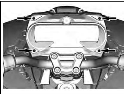
4. Déposez l'indicateur en comprimant les languettes de retenue et débranchez le connecteur.
