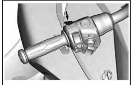
**REMARQUE :** Le bouton BRP Connect est utilisé pour un accès rapide à BRP Connect. Chaque clic permutera entre la vue des applications et la vue des fonctions de l'indicateur multifonction.
