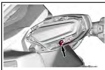
2.2 Retire el tornillo del extremo de la carcasa del retrovisor.
