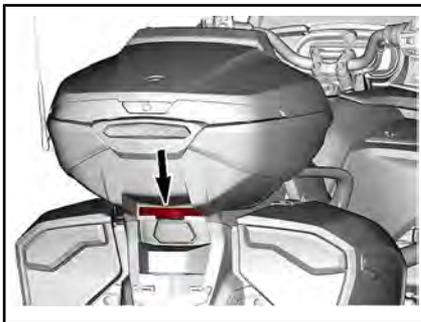
4. Levante ligeramente el compartimento de almacenamiento y deslice la mano por debajo para desenchufar el conec-
