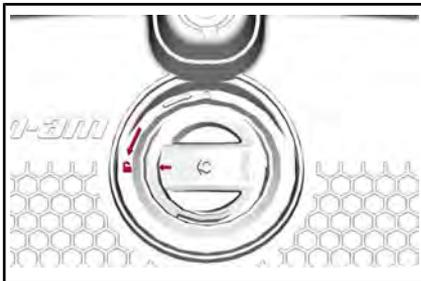
3. Utilizando la palanca trasera, desenganche el compartimento de almacenamiento de la parte superior del vehículo.
