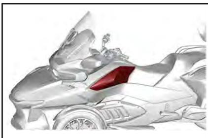
La tapa de acceso izquierda se puede desmontar para acceder al filtro de aire del motor.
