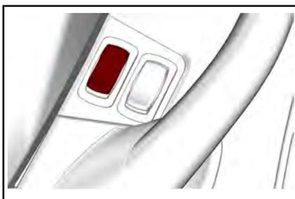
El interruptor de los asientos con calefacción permite activar y desactivar la calefacción de los asientos y controlar la intensidad del calentamiento.
