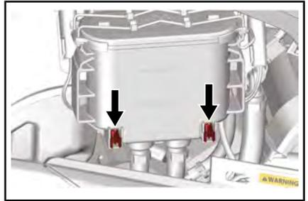
14. Mueva el depósito hacia atrás y sujételo con una cuerda elástica al manillar.
