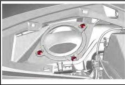
2. Retire la cubierta del filtro de aire y el filtro.
