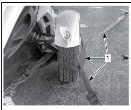
**TÍPICO - SUJECIÓN DE LAS RUEDAS DELANTERAS MÉTODO 2**
