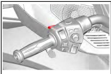
El botón BRP Connect se utiliza para acceder rápidamente a BRP Connect. Cada clic cambiará entre la vista de aplicaciones y la vista de funciones del indicador multifunción.
