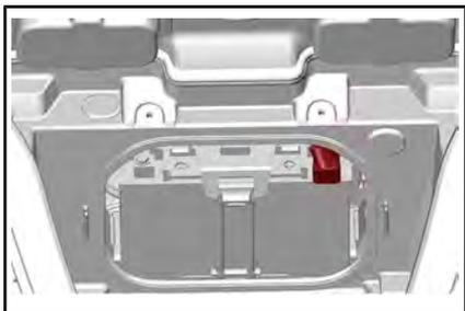
6. Empiece conectando uno de los extremos del cable de puente de color ROJO al borne positivo (+) de la batería descargada.
