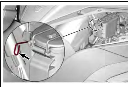
13. Suelte los dos interruptores de nivel del freno de la parte inferior del depósito.
