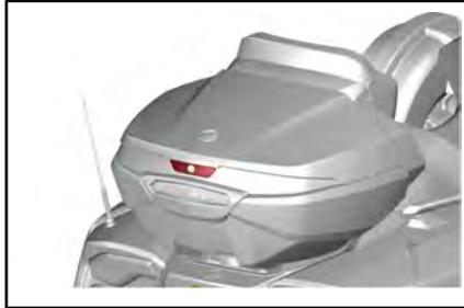
Tire del cierre hacia arriba para abrir la tapa. Si está bloqueado, utilice la llave de contacto para desbloquearlo.
