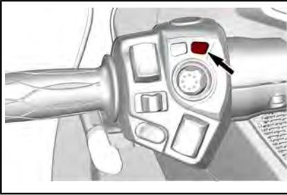
**NOTA:** Se necesitan 11 V como mínimo para activar el freno de estacionamiento. Si el voltaje de la batería es inferior a 11 V, el testigo del freno de estacionamiento parpadeará y aparecerá un mensaje en el cuadro de instrumentos.
