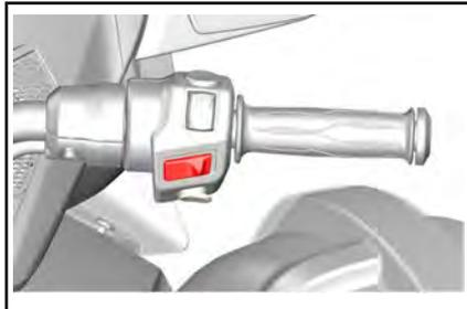
El interruptor es multifuncional. Permite activar, ajustar y detener el funcionamiento del control de velocidad de crucero.
