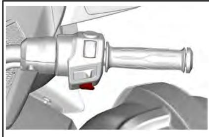
Cuando se presiona y se mantiene el tiempo necesario, arranca el motor.
