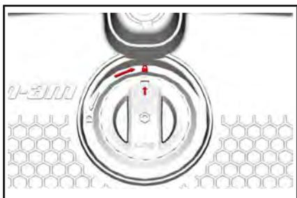
6. Coja firmemente el compartimento de almacenamiento y compruebe que esté correctamente instalado y bloqueado en el vehículo.
