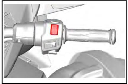
El interruptor tiene dos posiciones y debe colocarse en la de marcha (RUN) para poder arrancar el motor. Este interruptor le permite detener el motor en cualquier momento sin retirar la mano del manillar.
