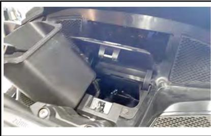
2. Introduzca la mano en el hueco y empuje hasta la parte de espuma de debajo de la pantalla para acceder a la consola. Es posible que sea necesario apartar el mazo de cables eléctrico para trabajar fácilmente.
