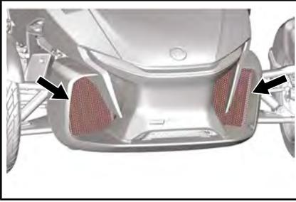
**NOTA:** Si el motor está en marcha y el vehículo está detenido o circulando a baja velocidad, los ventiladores del radiador envían aire hacia la parte delantera del vehículo. Si el vehículo circula a velocidad superior, los ventiladores envían aire a la parte trasera del vehículo.
