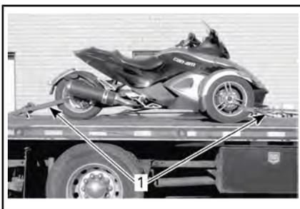
**TÍPICO - VEHÍCULO ORIENTADO HACIA EL REMOLQUE**
