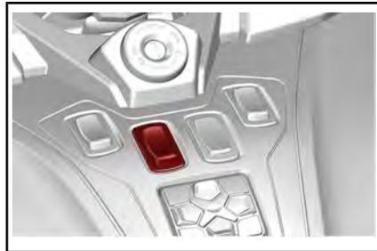
El interruptor de las empuñaduras con calefacción permite activar y desactivar la calefacción de las empuñaduras y controlar la intensidad del calentamiento.
