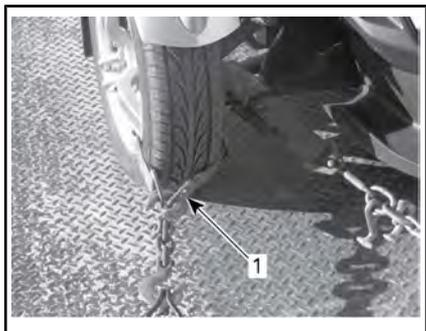
**TÍPICO - SUJECIÓN DE LAS RUEDAS DELANTERAS MÉTODO 1**
