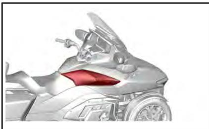
La tapa de acceso derecha se puede desmontar para acceder a los elementos siguientes:
