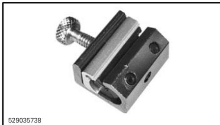
5. Insérez le pointeau du vaporisateur dans l'orifice de lubrification du câble.
