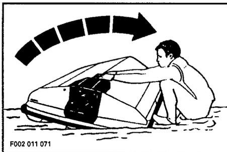
◆ **AVERTISSEMENT** : Ne jamais remettre la motomarine à l'endroit si le moteur reste en marche. Ne pas agripper la grille d'admission d'eau pour retourner la motomarine.
