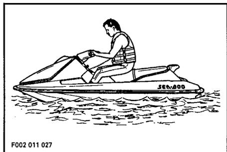
Fixer le cordon coupe-circuit au gilet de sauvetage du conducteur, et fixer le capuchon du cordon coupe-circuit sur l'interrupteur.
