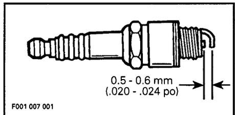
Remettre les bougies en place, les serrer solidement et rebrancher les câbles.
