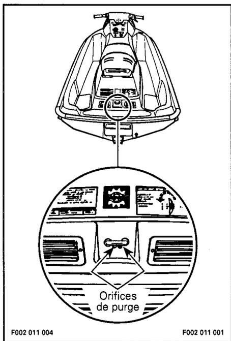
Lorsque le moteur fonctionne, l'eau doit s'écouler par ces orifices, ce qui permet à l'air de s'échapper des chemises d'eau du tuyau d'échappement calibré et du moteur et indique qu'il y a circulation dans le système de refroidissement.
