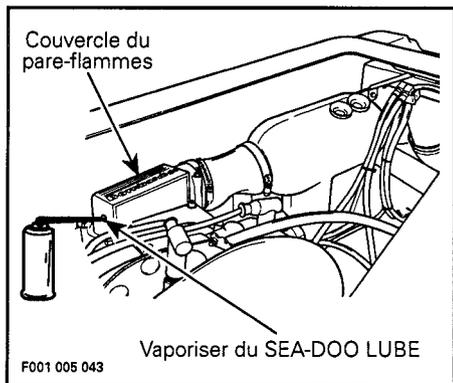
La lubrification du moteur devrait se faire pendant au moins une minute. Après environ 30 secondes, fermer la soupape du réservoir de carburant et faire tourner le moteur jusqu'à épuisement du carburant tout en continuant de lubrifier.
