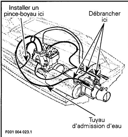
Élever tous les tuyaux au-dessus du point le plus haut du tuyau d'échappement calibré et les attacher temporairement ensemble.
