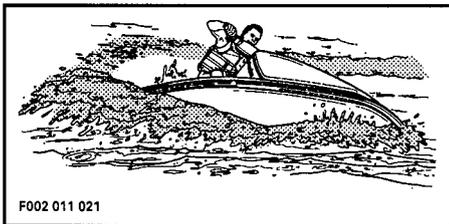
Le déplacement du guidon fait pivoter la tuyère de la turbine pour ainsi diriger la motomarine. Si on tourne le guidon vers la droite, la motomarine tournera à droite, et vice versa. On doit appuyer sur l'accélérateur pour faire tourner la motomarine.
