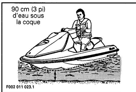
◆ **AVERTISSEMENT :** Le moteur doit être arrêté avant qu'il n'y ait moins de 90 cm (3 pi) d'eau sous la coque. La turbine pourrait aspirer des coquillages, du sable, des cailloux ou autres objets ; ce qui pourrait endommager l'hélice, les composants, ou encore obstruer ou bloquer le système de refroidissement.
