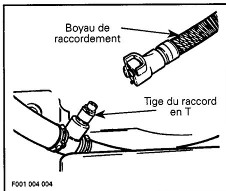
Relier l'autre extrémité du boyau de raccordement à un tuyau d'arrosage. Ne pas ouvrir le robinet immédiatement.
