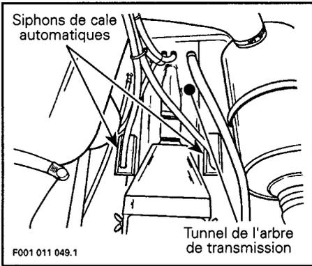
Cette motomarine est munie de siphons à dépression. Deux siphons utilisent une zone de basse pression à l'intérieur de la turbine pour aspirer l'eau hors de la cale.
