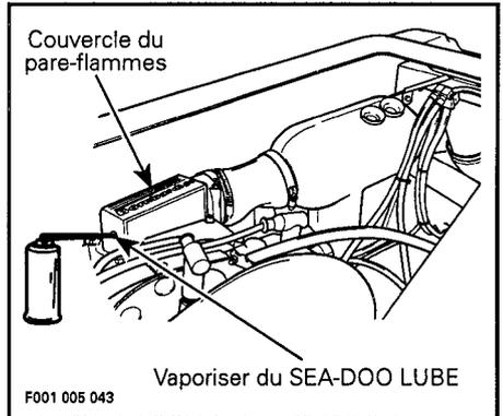
La lubrification du moteur devrait se faire pendant au moins une minute. Après environ 30 secondes, fermer la soupape du réservoir de carburant et faire tourner le moteur jusqu'à épuisement du carburant tout en continuant de lubrifier.
