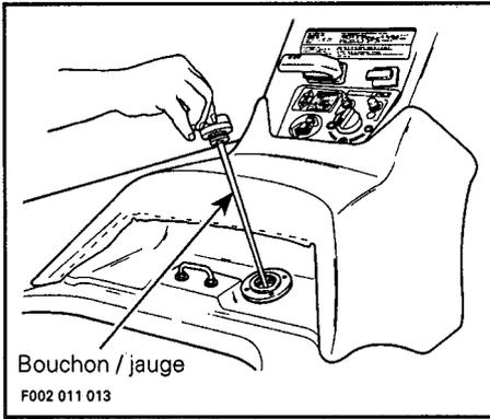
La jauge indique la quantité d'huile à ajouter dans le réservoir. Le niveau d'huile devrait toujours se trouver entre les marques «FULL» et «ADD». Pour vérifier le niveau d'huile, placer la motomarine au niveau, essuyer la jauge et l'insérer ensuite dans le réservoir. Ne pas visser le bouchon. Enlever la jauge et observer le niveau.
